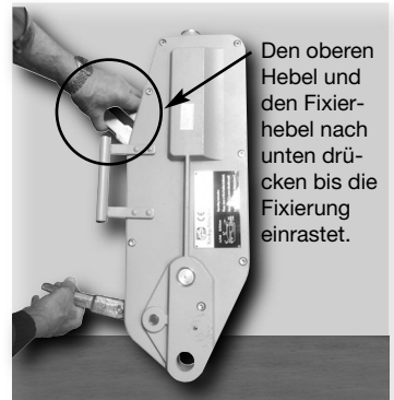
Abb. 3 Drücken Sie nun den oberen Hebel und den Fixierhebel mit einer Hand zugleich kräftig mit hohem Druck nach unten bis die Fixierung einrastet.
