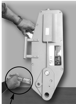
Abb. 2 Stellen Sie den unteren Bedienhebel waagrecht.
